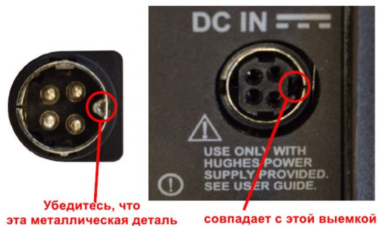
Рисунок 6. Разъем шнура питания.
