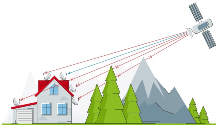
Рисунок 23. Выбор места для установки опоры антенной системы
