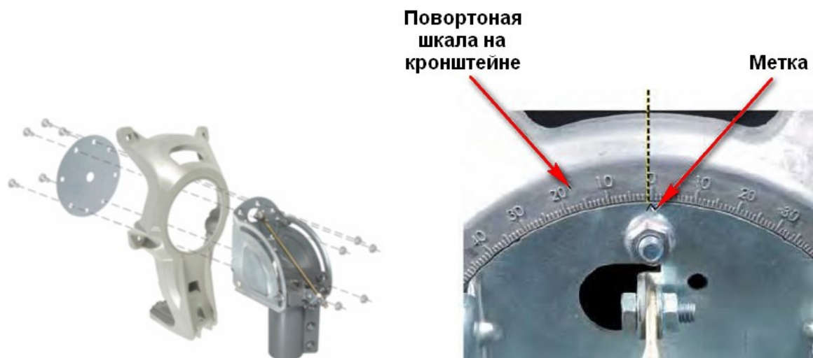
Рисунок 31. Крепление кронштейна к опорно-поворотному устройству
