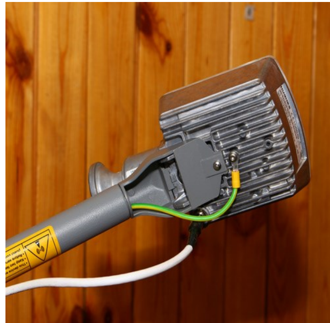
Рисунок 37. Крепление проводников заземления на антенне 0.74м
