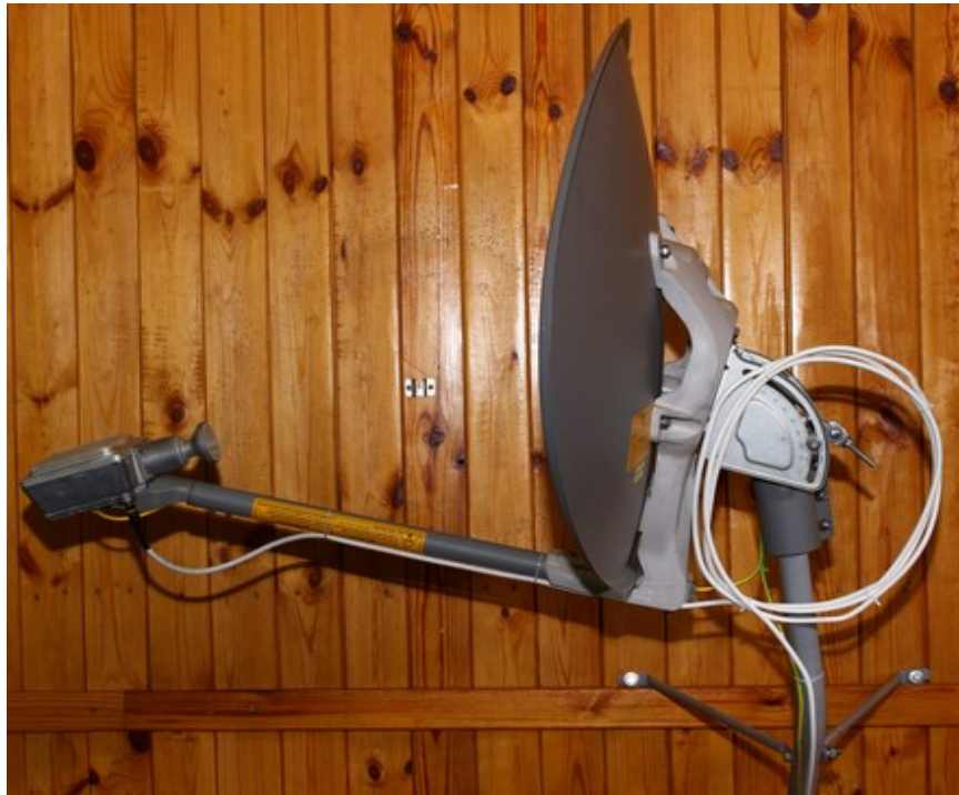
Рисунок 39. Прокладка коаксиального кабеля
