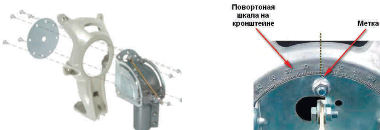
Рисунок 23 – Крепление кронштейна к опорно-поворотному устройству
